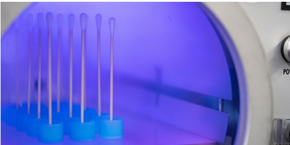
Abb. 1: Abstrichtupfer in der Laborplasmaanlage
